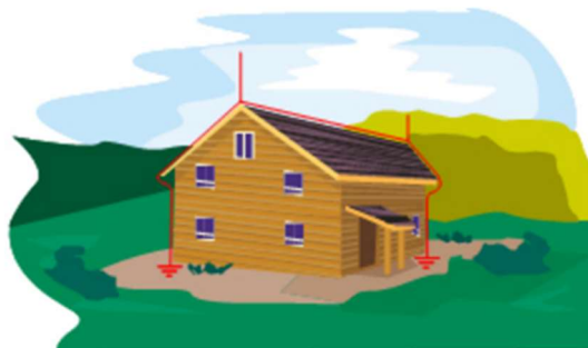
Figura 17 - Sistema de terra tipo A
